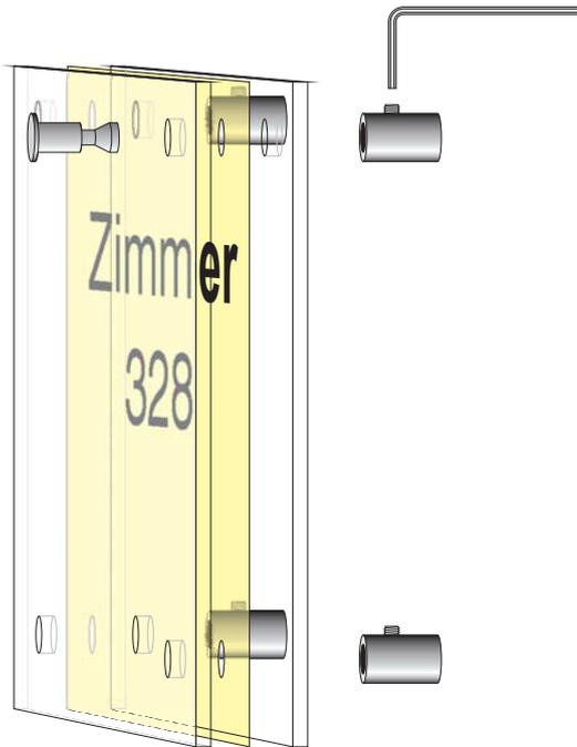
Die Glasscheiben mit der gelochten Beschriftungsfolie auf die Halter setzen. Die Befestigungsbolzen eindrücken und mit der Inbusschraube arretieren.
